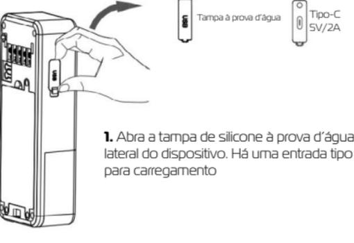
1. Abra a tampa de silicone à prova d'água na lateral do dispositivo. Há uma entrada tipo C para carregamento
