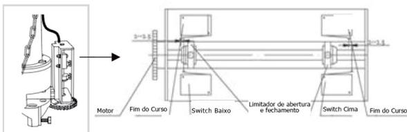
*Para regular el limitador de apertura y cierre (carrera m) de la puerta, será necesario regular la posición del microinterruptores:*
