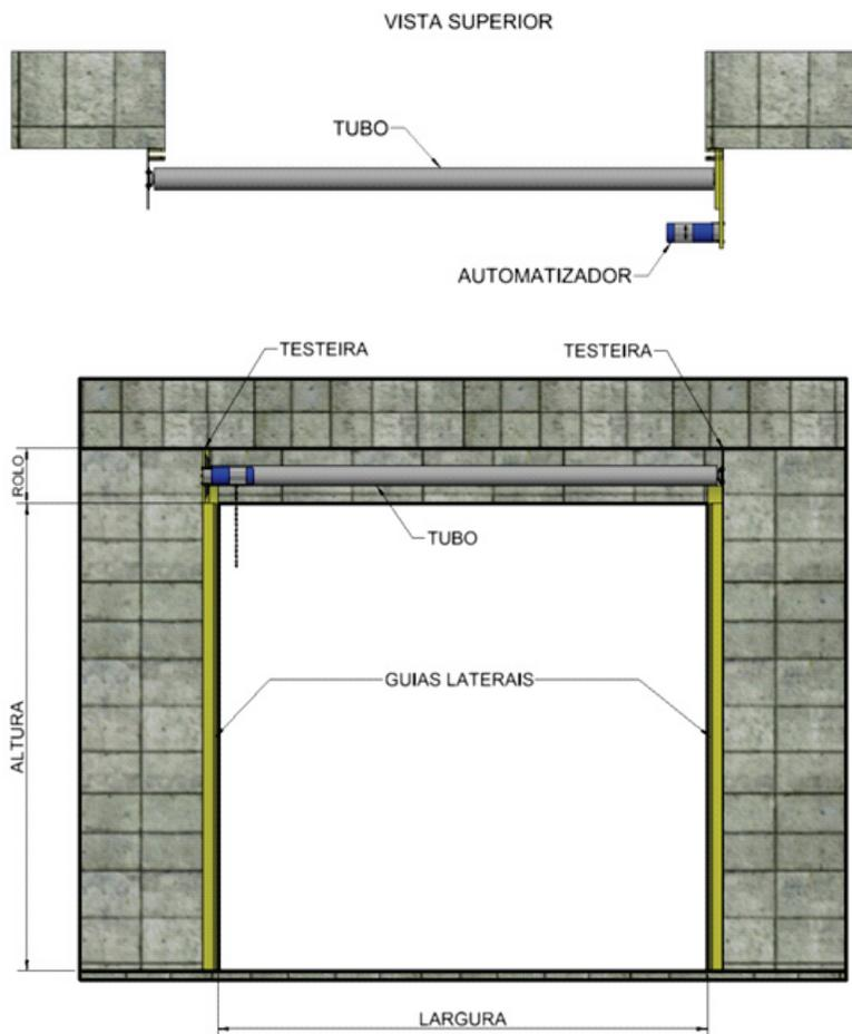
Quantidade de lâminas =  $(\text{ALTURA} + 400 \text{ mm} / 75) + 5$  (LÂMINAS DE AÇO)
