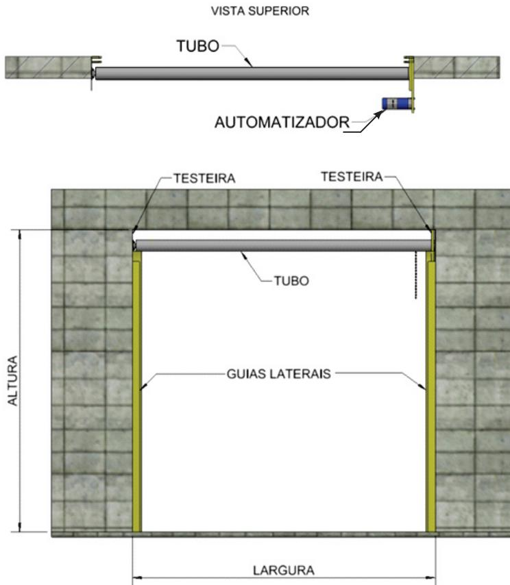
Quantidade de lâminas =  $(\text{ALTURA} / 75) + 5$  (LÂMINAS DE AÇO)
