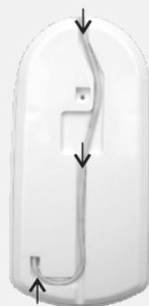
*Para evitar a entrada de água no sensor é de extrema importância, seguir a recomendação de entrada de fio utilizando a canaleta conforme figura ao lado.*
