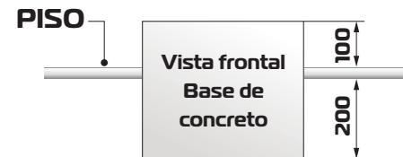
Posicione o equipamento com cuidado até o local com a base de concreto para a instalação, retire a porta do mesmo e faça as marcações para fazer o furo de fixação conforme imagem abaixo. Retire o equipamento do local, confirme as medidas e fure com uma broca de 12mm
