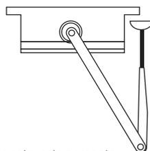
3 - Faça a fixação do antebraço da mola com seu parafuso de fixação e coloque a tampa do eixo na parte inferior.
