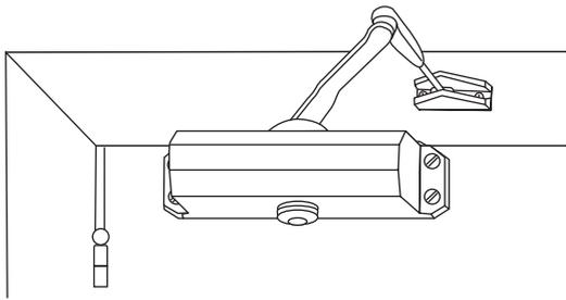
A mola sempre deve ser instalada com as válvulas viradas para o lado das dobradiças da porta. Mola do lado de abertura.
