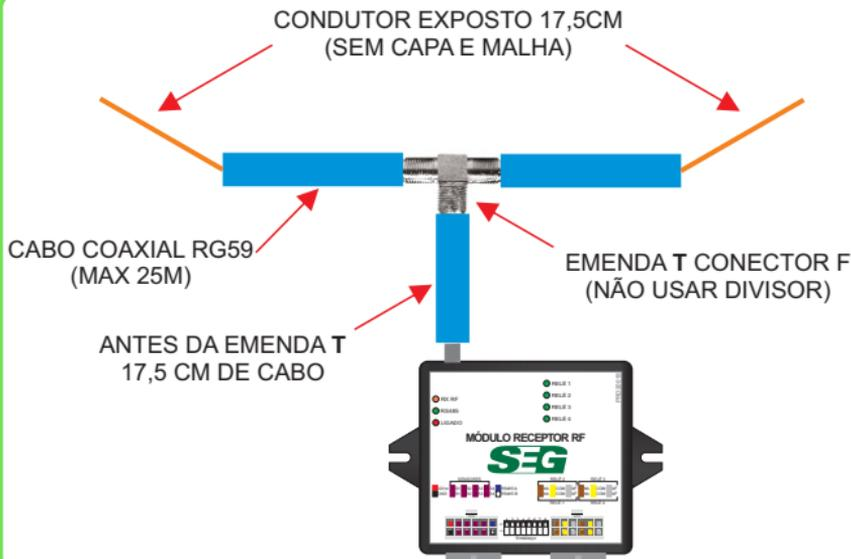
Uma dica para situações em que necessita-se fazer a divisão da antena do Módulo RF, deve usar cabo coaxial RG59 e emenda T tipo F. Para a melhor performance do sinal de RF a instalação deve seguir o desenho ao lado. Qualquer dúvida, entre em contato com nosso suporte.
